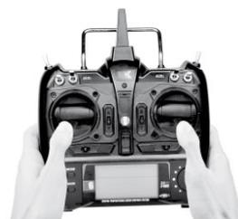
**HINWEIS:** Wenn Sie den Sender einschalten und der Gas-Halte Schalter steht auf An oder der Gashebel steht nicht in der untersten Position, ertönt ein Alarm. Schalten Sie den Gas-Halt Schalter auf aus und drücken Sie den Gashebel nach unten.
